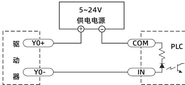
Y0接成sourcing型输出，与PLC的输入相连
