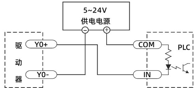
Y0接成sinking型输出，与PLC的输入相连
